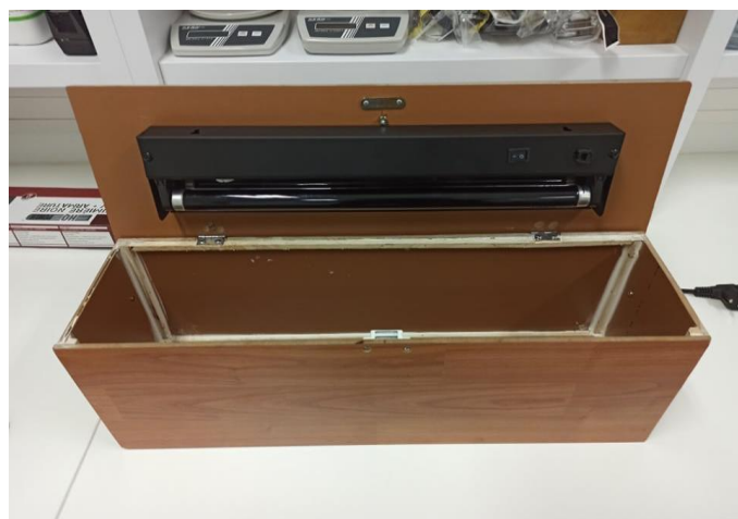
Slika 5. Kutija s UV žaruljom valne duljine 365 nm u kojoj će otopine DNA iz sperme lososa biti tretirane
